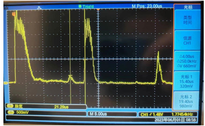
图 4: 一二级孔深回波 \Delta t_2
