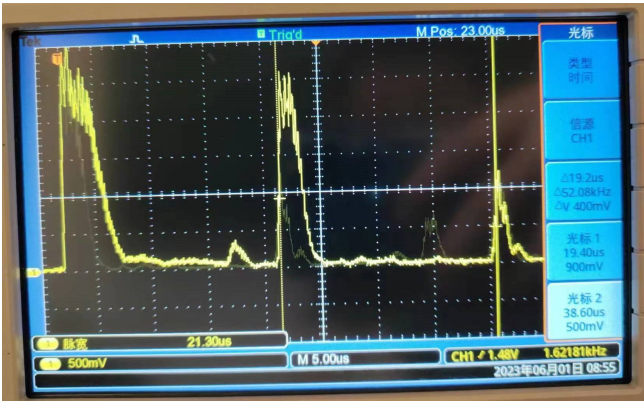
图 3: 一二级全高度回波 \Delta t_1
